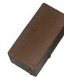
Povrch dlažby bez vápenného výkvětu
