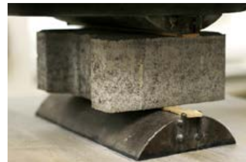
DLAŽBA PŘI ZKOUŠCE PEVNOST V PŘÍČNÉM TAHU
