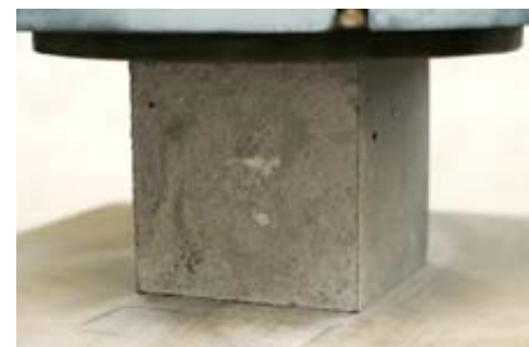
BETON PŘI ZKOUŠCE PEVNOST V TLAKU
