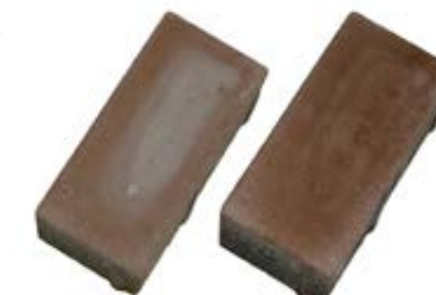
Povrch dlažby s vápenným výkvětem před čištěním a po vyčištění Rebanitem S
