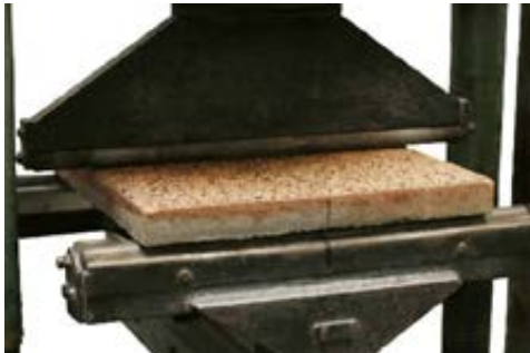
DLAŽBA PŘI ZKOUŠCE PEVNOST V OHYBU
