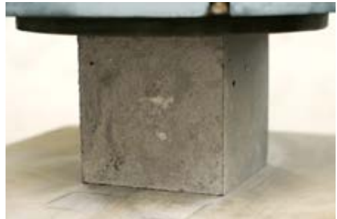
BETON PŘI ZKOUŠCE PEVNOST V TLAKU
