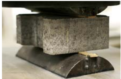
DLAŽBA PŘI ZKOUŠCE PEVNOST V PŘÍČNÉM TAHU
