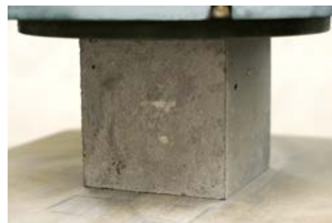
BETON PŘI ZKOUŠCE PEVNOST V TLAKU
