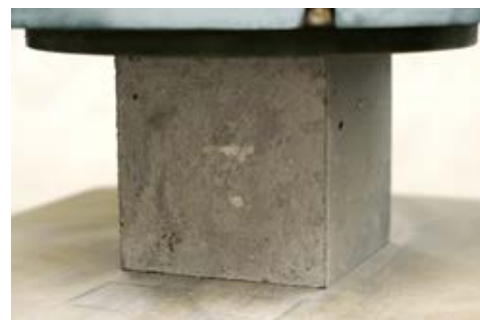
BETON PŘI ZKOUŠCE PEVNOST V TLAKU
