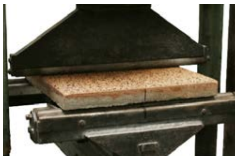
DLAŽBA PŘI ZKOUŠCE PEVNOST V OHYBU
