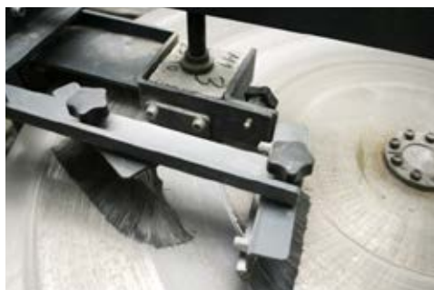
DLAŽBA PŘI ZKOUŠCE OBRUSNOST POVRCHU
