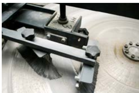
DLAŽBA PŘI ZKOUŠCE OBRUSNOST POVRCHU
