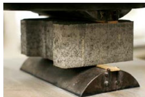
DLAŽBA PŘI ZKOUŠCE PEVNOST V PŘÍČNÉM TAHU
