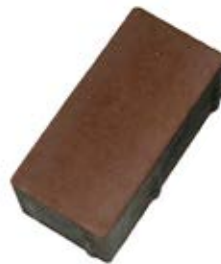
Povrch dlažby bez vápenného výkvvětu
