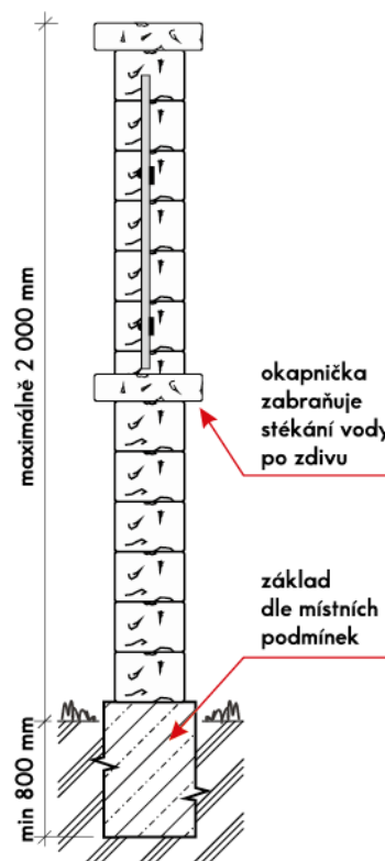
Obr. č.9 Příklad plotové konstrukce
