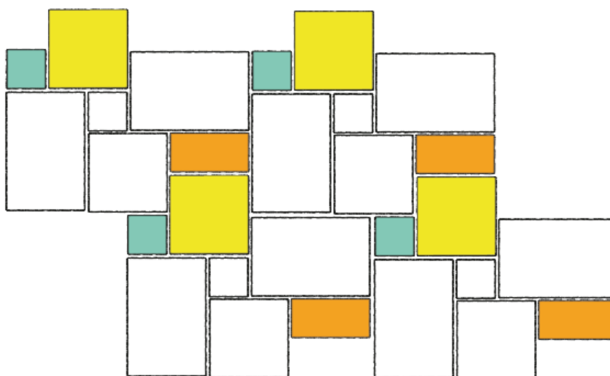
Obr. č. 8 – Rozložení čtyř vrstev s narušením dlouhých spár výměnou kamenů
