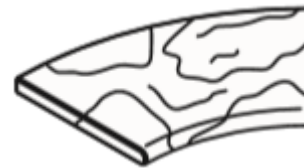
Obr. č.4 – Bazénový lem Gabro - rohový vnitřní 1m segment 45°
