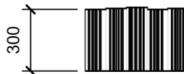
Obr. č.3 PALISÁDOVÝ OBRUBNÍK VZOR DUB – boční pohled
