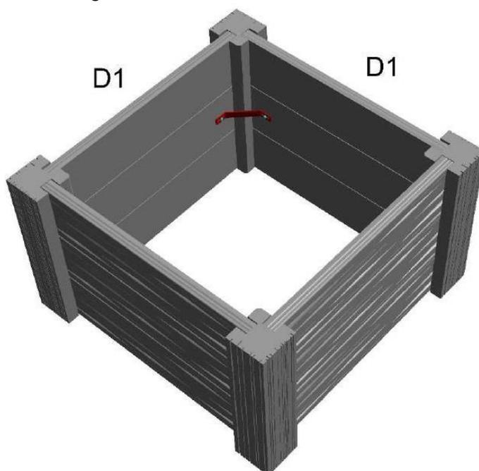
**ABSCHLIEßEND:** Einzelne Bauteile des BEETES während der Montage befestigen, jedoch nicht festziehen, um ein kleines Spiel beim Zusammenbau von anderen Bauteilen zu erhalten. Die Bauteile erst nach dem erfolgten Zusammenbau von allen Bauteilen des BEETES endgültig festziehen. Das endgültige Festziehen ist mit einem gewissen Gefühl durchzuführen, damit die einbetonierten Gewindehülsen nicht herausgerissen werden.
