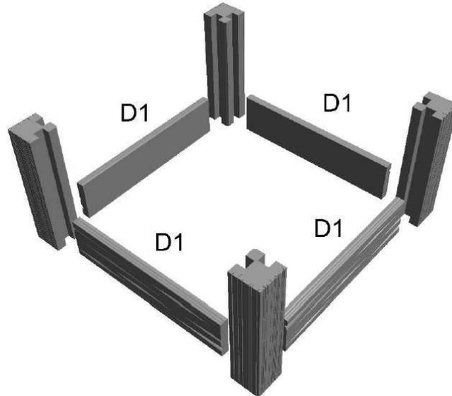
3. Auf die erste Schicht der Bretter **D1** zwischen die Pfosten **A** die Bretter der zweiten Schicht **D1/A** mit Gewindehülsen einlegen.
